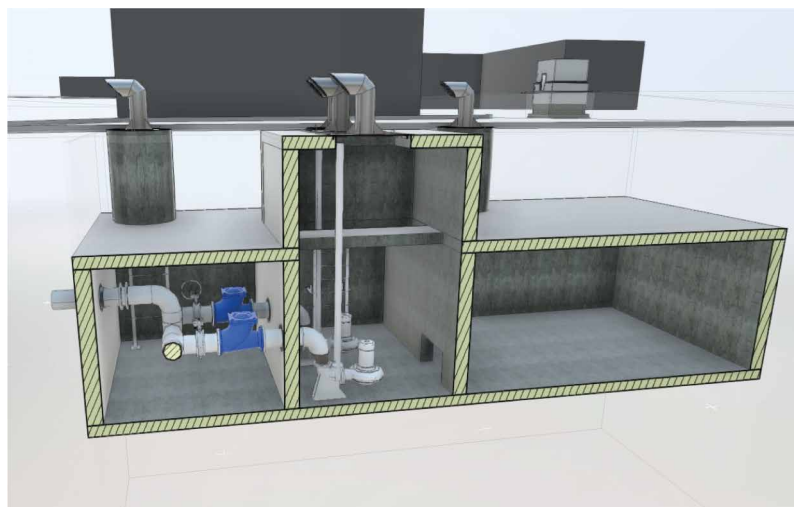
Насосная станция опорожнения аэротенков
