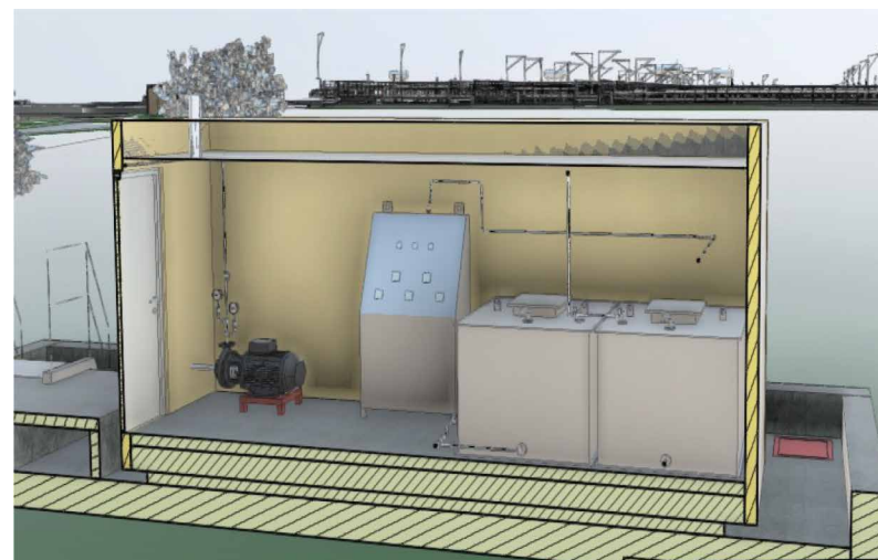
Станция дозирования овицида
